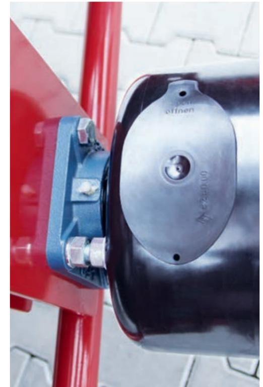
Conducto del eje de transmisión del tractor hacia el engranaje de la mezcladora con cabezal protector para el eje
