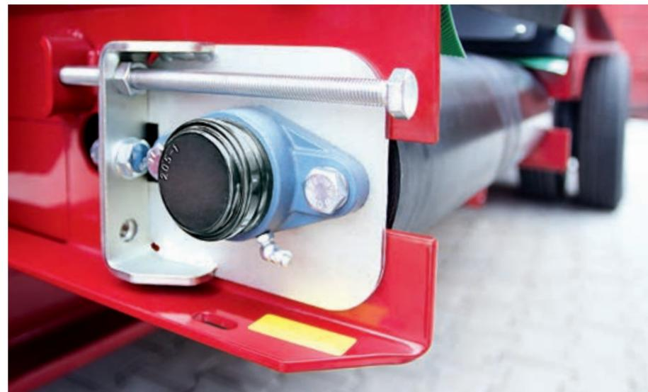
Tensor para la correa de goma de la cinta transportadora, con bridas de dos orificios y tapa protectora
