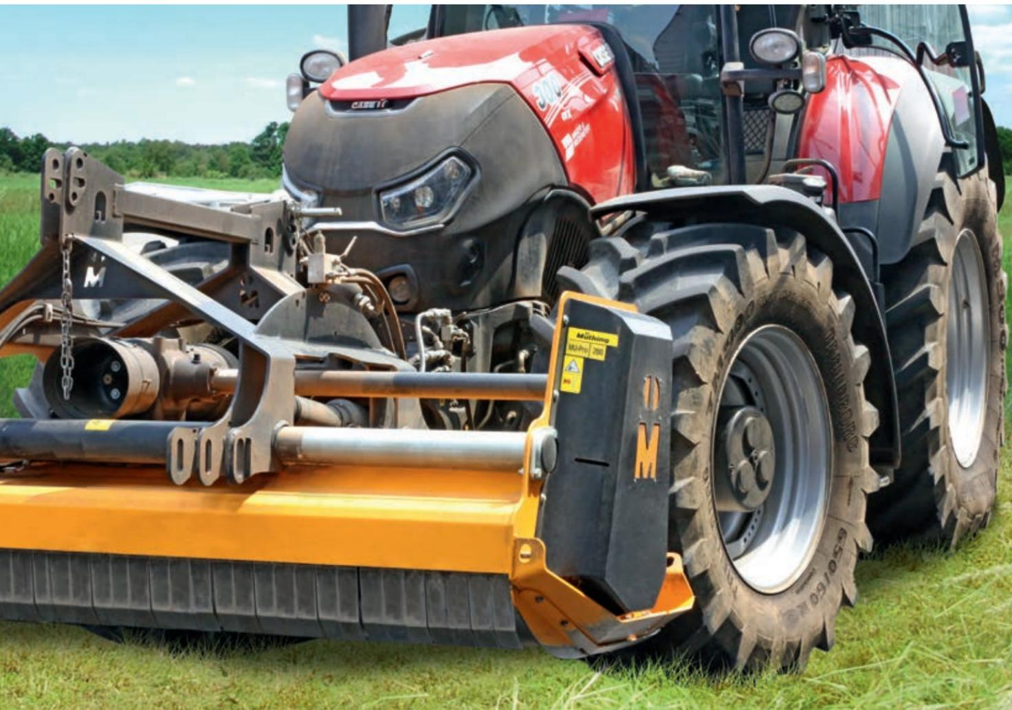
La desbrozadora Muthing MU-Pro Vario está diseñada para alcanzar los 220 CV de potencia motriz. Se trata de la potencia del motor que se puede ejercer sobre el eje de transmisión para cada anchura de trabajo. Este dato revela la potencia que reciben los grandes rodamientos LFD en el eje del rotor.
